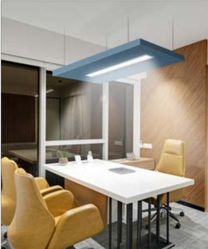
Die LED Panel PIAZZA/R werden normalerweise als Lichtquelle für den Einbau in Deckenöffnungen verwendet. Als Akustikleuchte dient der rundumlaufende Falzrand 15 mm pro Seite als Auflage für den Akustik-Einsatz. Anstelle der Snap-In-Federn werden die Stahlseile für Hängeleuchten montiert.
